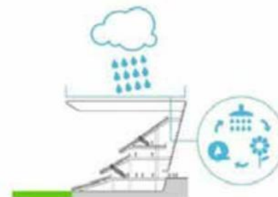
РИСУНОК 17 Збирання дощової води на даху стадіону.
